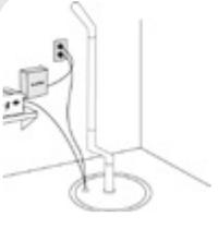
Installer une pompe de puisard de secours et une batterie\*
